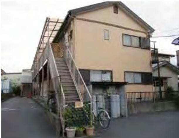
手前の階段は傾斜がきつく危険なため使用禁止とし、奥に屋根付の階段を新設している。
